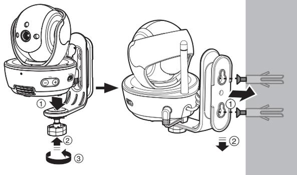
Placez l'unité du bébé sur le support mural. Serrez la vis dans la douille fileté au fond pour fixer l'unité du bébé. Alignez les trous du support mural avec les vis du mur et glissez le support vers le bas jusqu'à ce qu'il se verrouille en place.
