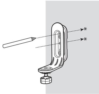
**NOTE :** Vérifiez la puissance de réception et l'angle de la caméra avant de percer les trous.
