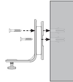
Alignez le support mural et les vis avec les trous du mur, tel que démontré. Serrez la vis dans le trou du milieu d'abord, afin de fixer la position de montage mural. Vous pouvez serrer l'autre vis dans le trou supérieur.
